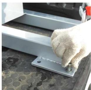
荷台リガーをベースに差し込みボルトを締め固定。
