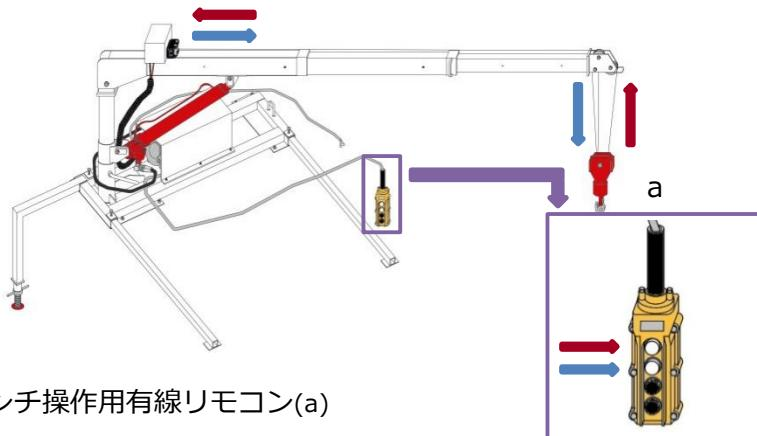
電動ワインチ操作用有線リモコン(a)
